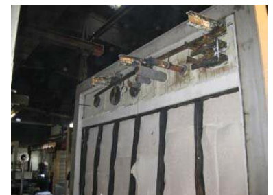
Abb. 10.: Feuerzugewandte Seite des Versuchsaufbaus, nach Versuche
